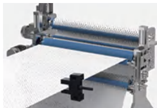
槽型光电检测位置偏移
