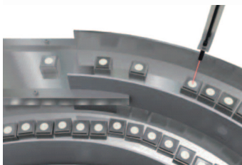
检测LED灯珠的正反面
